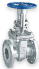
Gate Valve, OS & Y, ANSI 150# / 300# / 600# RF End
